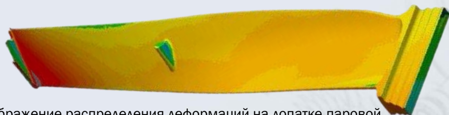
Изображение распределения деформаций на лопатке паровой турбины после обработки
