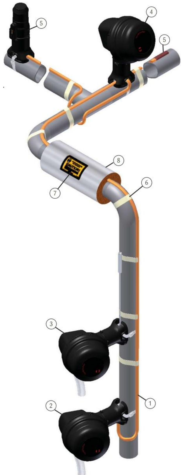
Рисунок А. Стандартный вариант установки кабельной системы обогрева.
