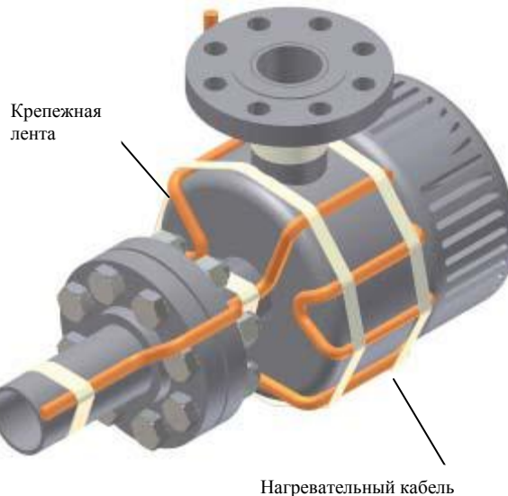
Монтаж кабеля на насосе
