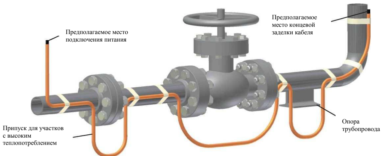
Рисунок В. Предварительная установка нагревательного кабеля
